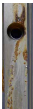
Rail HIREs (non chargé) après 32 heures de test au brouillard salin (selon DIN EN ISO 9227)
