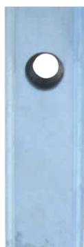
Rail avec revêtement CTS – après un mois de stockage à l'air libre
